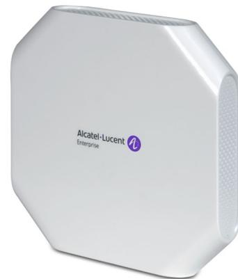
L'AP1101 OmniAccess est un point d'accès sans fil intérieur à double fréquence radio, 802.11ac, 2x2 MIMO. Optimisé par un processeur multicœur, l'AP1101 OmniAccess permet de coder et décoder rapidement, et offre un accès multi-utilisateur fiable. Il prend en charge un débit de données sans fil de 1,2 Gbit/s et une association de 64 clients simultanés au maximum.
